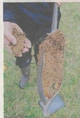
Des sondages effectués à l'aide d'une tarière.
